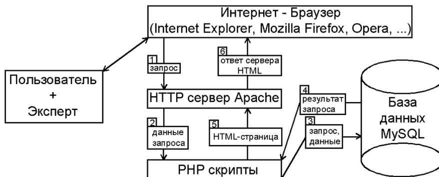
Рис. 1. Схема функционирования информационной части системы
